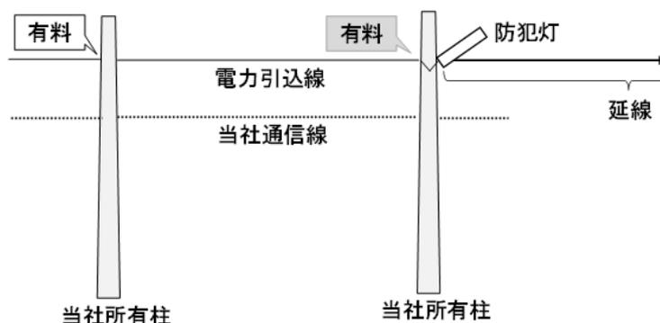
(図 1-2) 電力引込線延線時の電柱使用料
